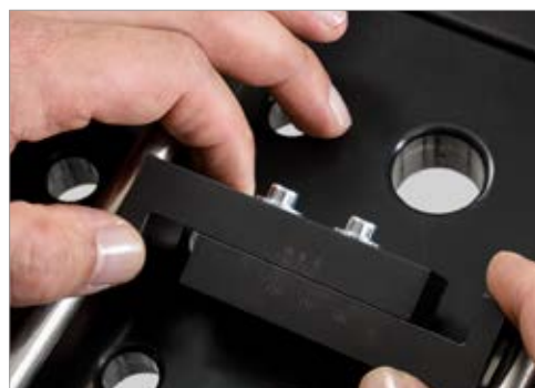
Einsetzen der Abstandslehre
