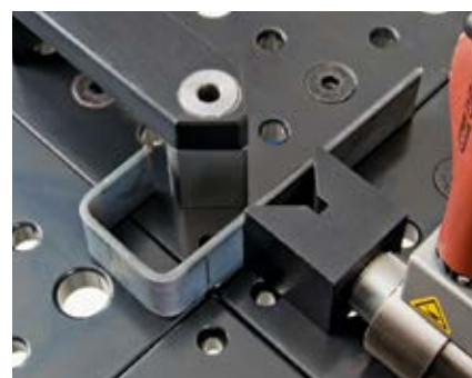
Kanten von Flacheisen 60x8 mm
