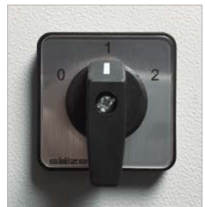
zwei Biegegeschwindigkeiten
