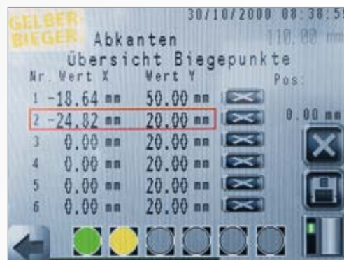
Programm mit zwei Biegewinkeln
