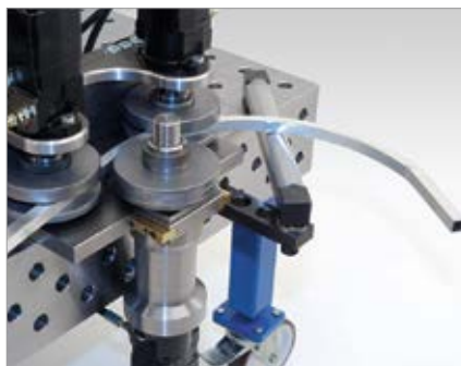
Biegen von Alu 25 x 25 mm Rohr
