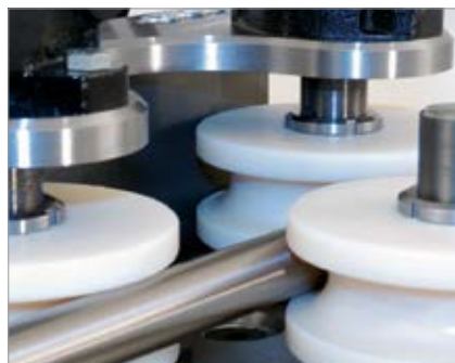
Polyamidwalzen und VA Rohr
