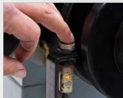
Näherungsschalter bestimmt den Anfang des Programmes
