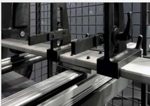
Gesteuerter Hinteranschlag mit Klappanschlag
