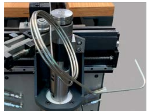
Freiformbiegen Kombiniert mit Biegen
