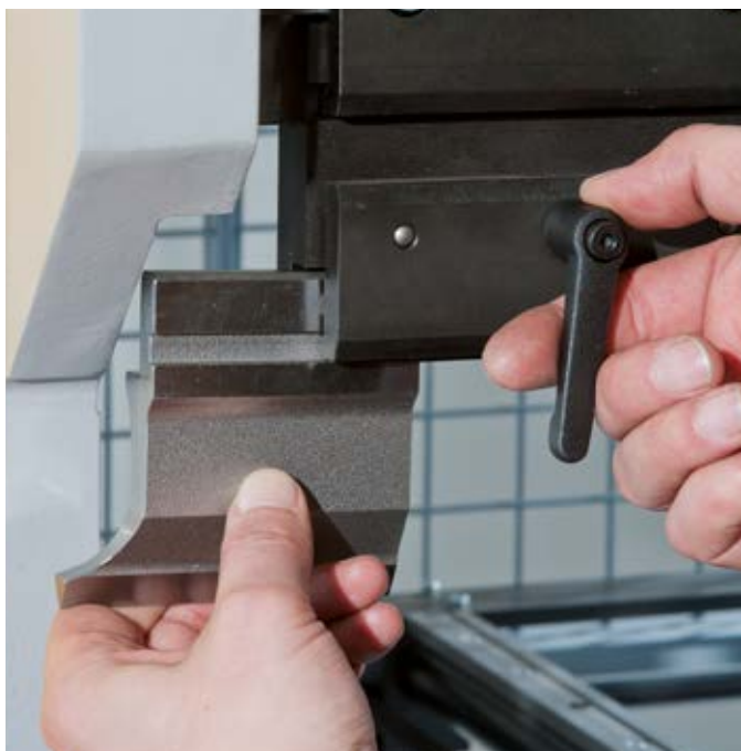
Stempel kann zur Seite entfernt werden
