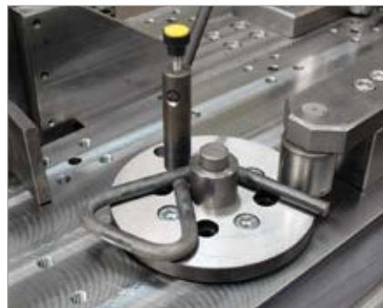
Drehteller zum Aufwickeln
