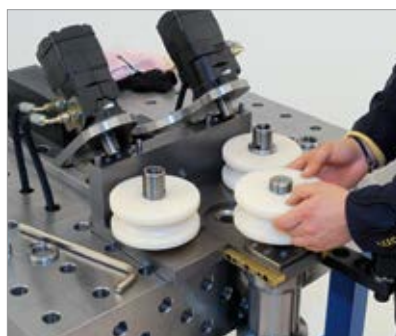
Wechseln der Biegewalzen
