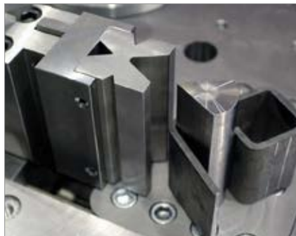
Biegedorn für enges Biegen
