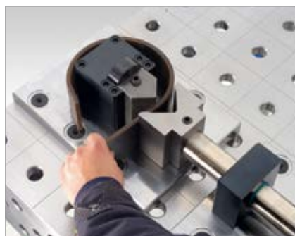
für geschlossene Teile; Matrice drückt in Stempel
