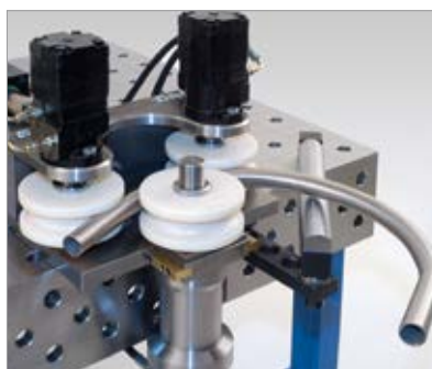
Walzen von VA Rohr Ø 33 mm
