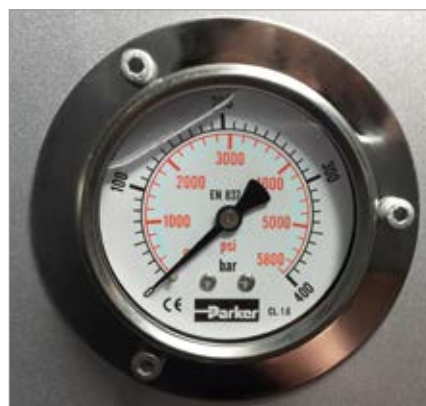
einstellbarer Spanndruck
