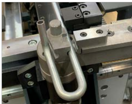
Biegen mit Booster 1,2 x D
