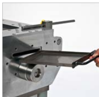
Schublade zum Auffangen vom Zunder
