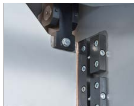
Einfache nachstellbare Führung
