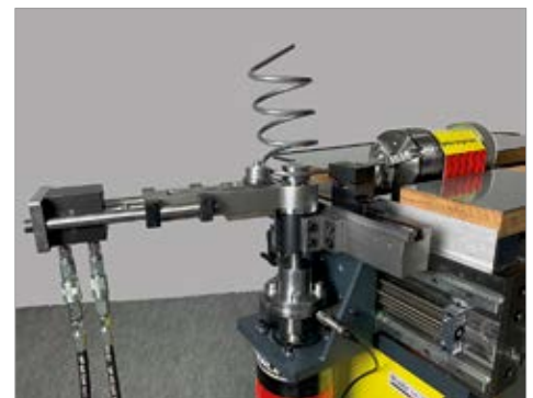
Spirale freiform und Biegen mit Steigung
