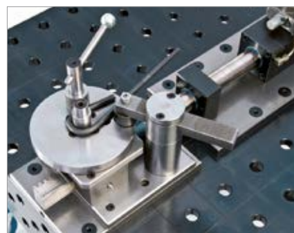
Hakenbiegen aus Rundmaterial
