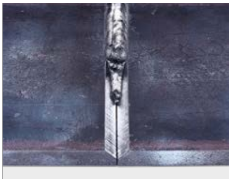
Schweissnahtvorbereitung: V-Naht
