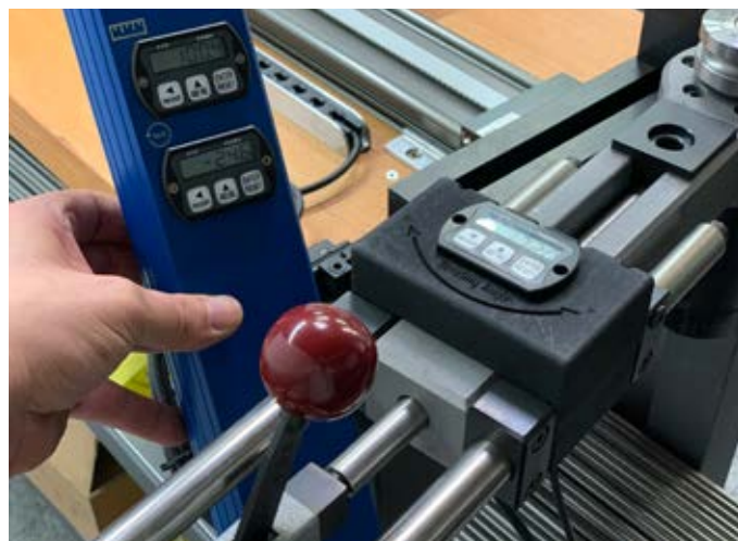
3 Digitalanzeigen / Länge, Verdrehung, Winkel
