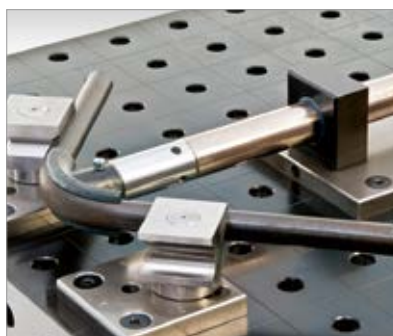
Rohrbiegen durch Drücken
