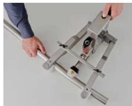
Biegen von Rohr 42 mm
