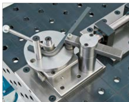
Aufwickeln von Flacheisen liegend
